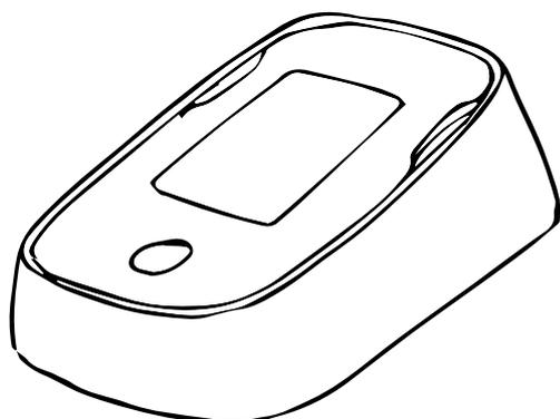
La base est connectée en permanence à votre capteur, affiche ses informations et les transmet par Internet sur votre smartphone. Elle sert également d'avertisseur sonore en cas d'intrusion, et d'interrupteur autonome pour désactiver cette alarme.
