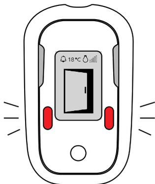
Quand la base est en mode alarme, elle signale l'ouverture de la porte par un **signal sonore continu** et un signal visuel (LEDs).
