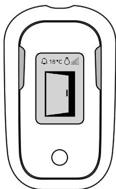
Quand la base est en mode muet, elle signale simplement l'ouverture de la porte par l'icône 'porte ouverte' **sans signal sonore**.
