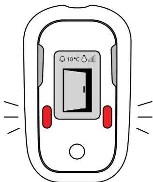
Quand la base est en mode carillon, elle signale l'ouverture de la porte par un **signal sonore ponctuel** et un signal visuel.
