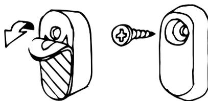
**Fixez l'aimant** sur le cadre de la porte, à l'aide de l'adhésif ou de la vis fournie, au plus près du capteur.
