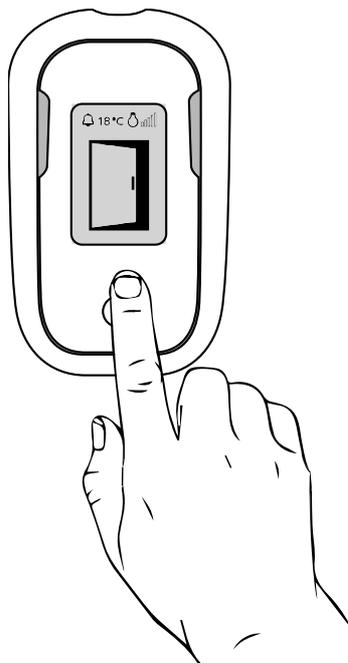
Lorsque l'alarme se déclenche, **l'arrêt se fait par un appui sur l'interrupteur principal.**
